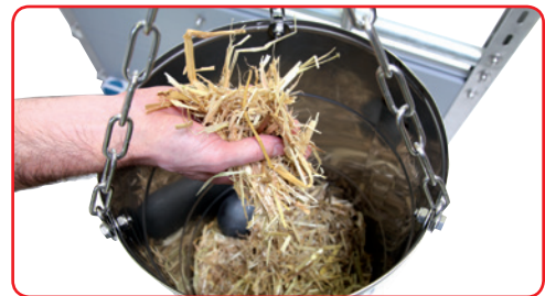
Strohnachführung durch Kugelmechanik
