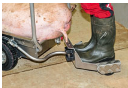
Die kleine Plattform zum Mitfahren ist werk- zeuglos im Nu montiert. Größere Räder sollen bis Anfang 2015 den Fahrkomfort verbessern.
