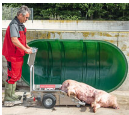
Am Kadaverlagerplatz angekommen, genügt ein Knopfdruck zum Abladen des Tieres.
