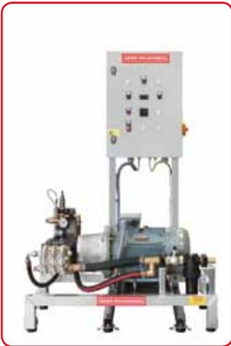
Höchste Flexibilität und Komfort bieten die frequenzgeregelt Pumpen für den Reinigungsvorgang. Angeschlossen an ein stationäres Leitungssystem bestimmen die Anwender die gewünschte Wassermenge. Durch die Frequenztechnik wird die Drehzahl verändert, so dass der Druck konstant bleibt und unterschiedlich viele Anwender mit unterschiedlichen Was-
