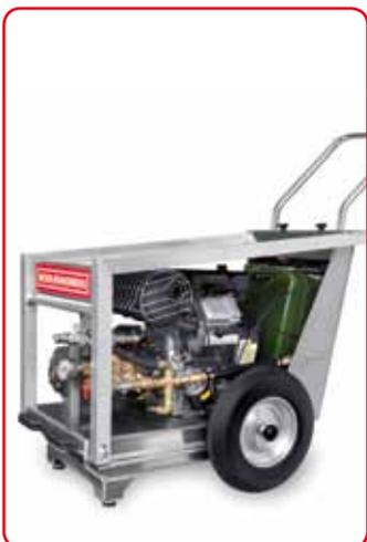
Der benzinbetriebene 16 kW-Motor macht den Anwender autark von jeglicher Infrastruktur. Der Elektrostarter sorgt für ein komfortables Anlaufen des Motors. Das Gerät gibt es mit einer Waschleistung von 1800 oder 1150 l/h. Mit großen Rädern ist der Hochdruckreiniger auch in unwegsamem Gelände gut zu manövrieren und ist so die ideale Besetzung an Baustellen und Außenposten.
