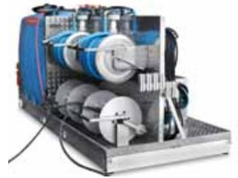
*Stationäre Hochdruckanlage auf einem PKW-Anhänger für einen professionellen Reinigungsdienstleister. Zwei robuste Plungerpumpen à 2.400 l/h, Vorlauf tanksystem mit 2 x 1.000 l und zwei Schlauchroller inkl. Schlauchführung mit je 100 m Hochdruck-Schlauch.*
