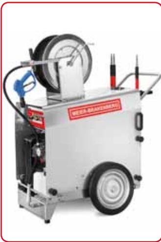
Die Ausstattung des Heißwassergerätes mit einer langsamlaufenden 3-Zylinder-Plungerpumpe und die Verwendung von Edelstahl- und Aluminiumbauteilen garantieren Langlebigkeit und Robustheit. Der Brenner wird mit Diesel oder Heizöl betrieben. Große Vollgummiräder sorgen für eine hohe Mobilität. Geeignet für die Maschinenpflege und überall dort, wo Eiweiße und Fette gelöst werden müssen.
