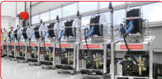
*Hochdruckreiniger mit 30 l/min für einen Speditionsbetrieb zur LKW-Reinigung im Außenbereich. Benzin-Motor mit 13 kW und Elektrostarter. Benzintank integriert - in Verbindung mit Brauchwassertank völlig autarker Betrieb möglich.*
