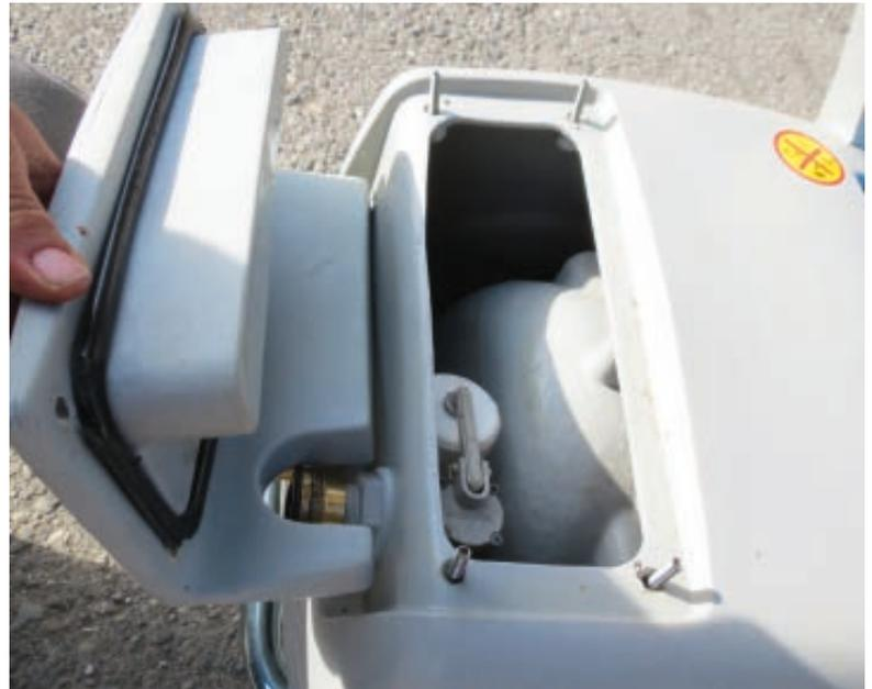
Im hinteren Teil des Chassis befindet sich der Schwimmertank mit einem Fassungsvermögen von 16 l.
