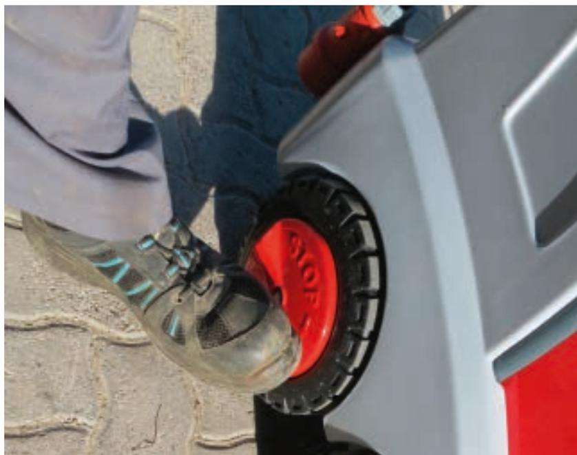
Am Tandemfahrwerk ist an der Hinterachse auf jeder Seite eine griffige Bremse integriert.
