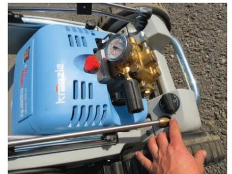
Auf der ausserhalb der Verschaltung montierten Pumpe ist ein Druckregler vorhanden.
