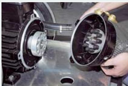
*Der jetzt doppelt gelagerte Motor und die doppelt gelagerte Pumpe von Annovi Reverberi sind bei Meier-Brakenberg über eine Kupplung verbunden.*
