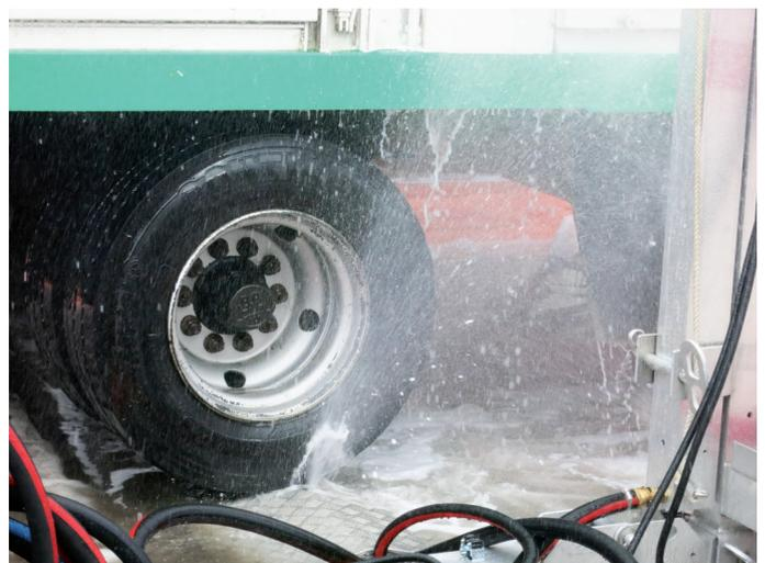
Verstärkter Düsenstrahl im Unterboden- und Felgenbereich
