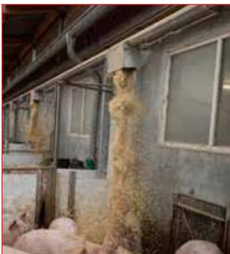
◀ Ausdosierung über Klappendosierer, die über Seilzug synchron geöffnet werden und für die Stroheinstreu der Liegefläche sorgen.
