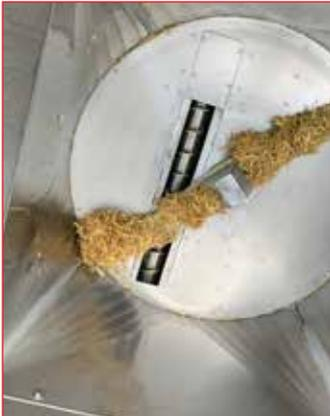
Die automatische Zufuhr von Einstreu oder Raufutter erfolgt durch einen Rohrkreislauf durch den eine Förderkette läuft. Das Stroh wird in einen großvolumigen Edelstahlvorratsbehälter aufgegeben, mit dem robusten Rührschwert werden die Ballen zerlegt und mit der Stopfschnecke in die Rohranlage übergeben. Umlenkecken aus Edelstahl sorgen für einen sicheren Strohtransport.
