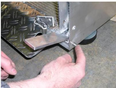
1. Schraube an der Fernbedienungsseite lösen und für Montage des Seitenteils im Holm versenken.
