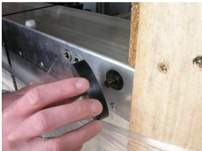
1. Falls unmontiert geliefert. WiegefüÙe mit einer U-Scheibe Zwischen Aufnahme und GummifuÙ montieren
