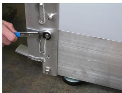
5. Anordnung Schrauben an den Ecken mit Fußpedal. 1 Stk. Schraube 10x60 in oberer der 3 Bohrungen. Schraube vom Fußpedal wieder nach außen durchschieben und Mutter aufschrauben. Mittlere Bohrung bleibt frei. Vorher gelöste untere Befestigungsschraube M8 der PVC-Bretter wieder festziehen.
