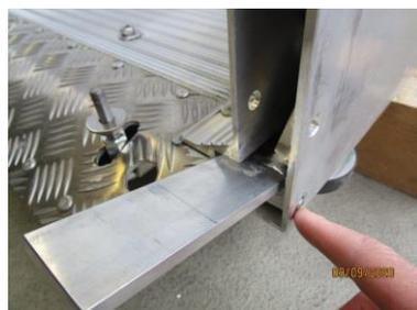
2. Mutter von der Schraube die das Fußpedal lagert entfernen und die Schraube für die Montage des Seitenteils im Holm versenken. Wird später wieder verschraubt
