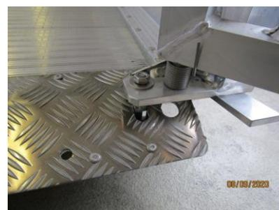
6. U-Scheibe und Mutter auf Stehbolzen aufschrauben. Falls erforderlich kann mit den Muttern ober und unterhalb der Scharnierlasche die Seitenwand und somit auch die Türen nachjustiert werden.
