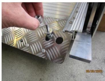
1. Entfernen Sie die obere Mutter und eine U-Scheibe vom Stehbolzen. Bauteile werden später montiert. Achtung untere Mutter nicht verdrehen.
