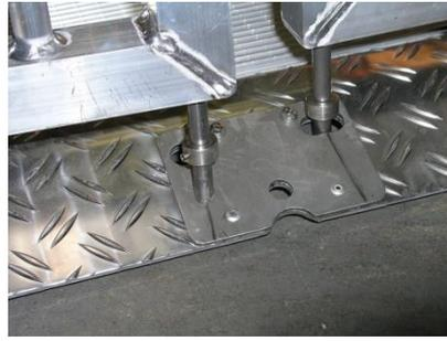
Einstellung Türöffner: Tor schließen, Mutter unter dem Griff so verschieben, dass die Türöffner-Stange so weit unten wie möglich das schräge Bodenblech erreicht, Mutter anschließend wieder festziehen
