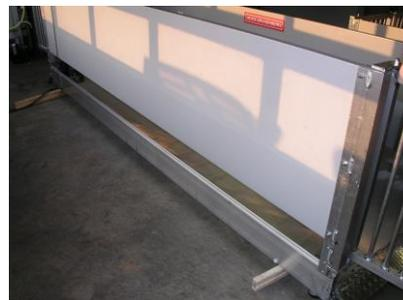
3. Gleichmäßiges Aufschieben der Eckpfosten auf die Seitenholme des Waagenbodens. Vor dem Aufschieben untere Befestigungsschrauben M8 von den PVC-Brettern an den Eckpfosten lösen.
