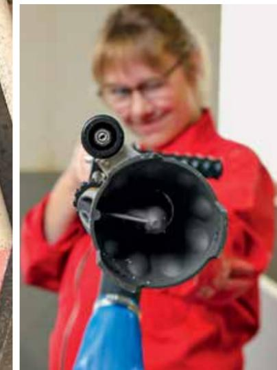
Seitlich neben dem Ansaugstutzen ist eine Spüldüse angebracht.
