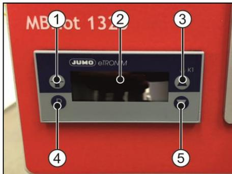
Die Sollwerteinstellung am Temperaturregler dient der Vorwahl der Heiztemperatur.
