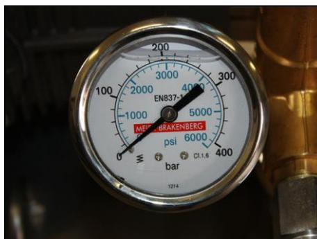
Die Druckanzeige (siehe Abbildung) dient dem Ablesen des Wasserdrucks auf der Hochdruckseite der Pumpe.
