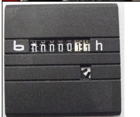
Die aktuellen Betriebsstunden lassen sich am Betriebsstundenzähler ablesen. Dieser befindet sich im Deckel der Steuerung.
