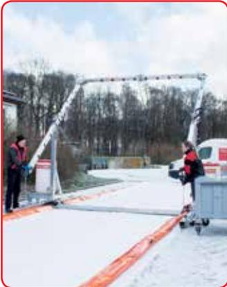
Das **DESTORmobil500** wird in akuten Seuchenfällen schnell und flexibel an Betriebs- und Sperrbezirksgrenzen aufgestellt. Fahrzeuge aller Art werden ohne Manpower automatisch dekontaminiert. Eine Hocheffizienzensensorik erkennt ein- oder ausfahrende Fahrzeuge und löst die Desinfektionspumpe
