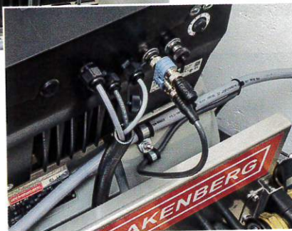
Per Drehknopf (Potenziometer) kann jeder Anwender den Maximaldruck einstellen.
