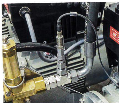
Der neue Drucktransmitter erkennt selbst kleinste und kurze Druckschwankungen.
