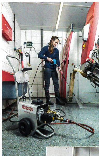
Die 3-Kolben-Plungerpumpe von Annovi Reverberi ist auf Dauereinsätze ausgelegt.
