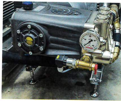
Annovi Reverberi stattet die Industripumpen für Meier-Brakenberg mit Extras wie mit Pleuel aus Bronze aus.
