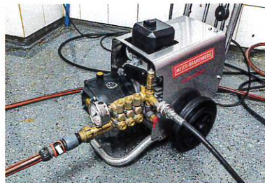
Die 3-Kolben-Plungerpumpe von Annovi Reverberi ist auf Dauereinsätze ausgelegt.
