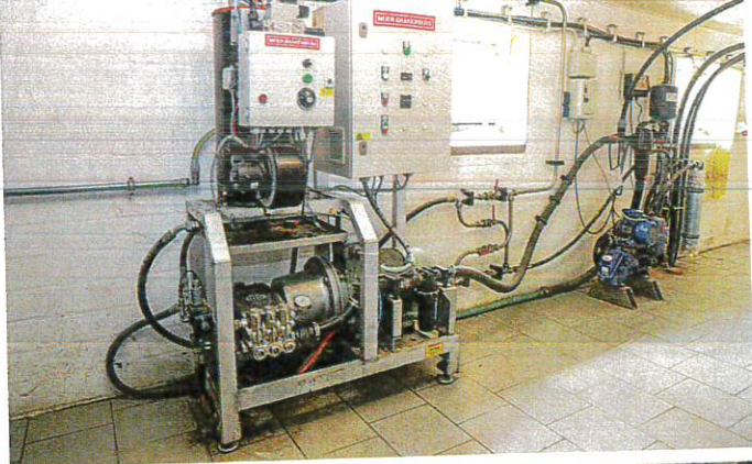
◁ Das Herzstück des stationären HD-Reinigers von Meier-Brakenberg befindet sich in einem frostsicheren Technikraum. Am Schaltschrank lassen sich Wassertemperatur und -druck einstellen.
