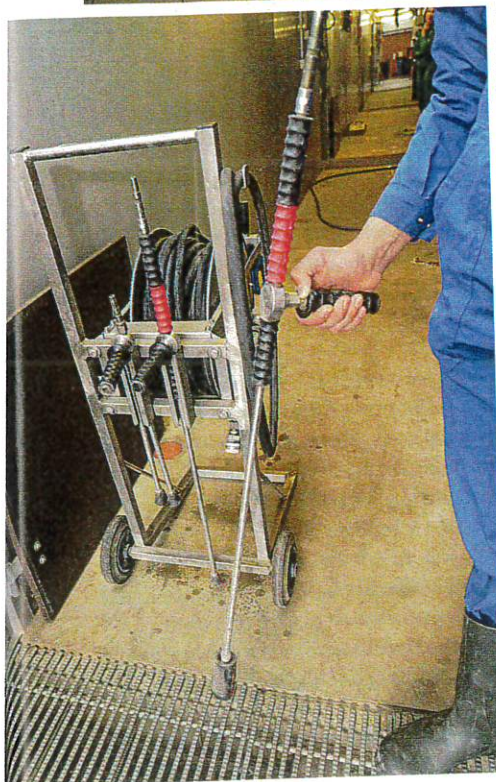
◁ Mit der kurzen Doppellanze duscht er die Sauen. Die Druckregulierlanze (Mitte) eignet sich zum Nachwaschen, die Pendellanze entfernt groben Dreck.
