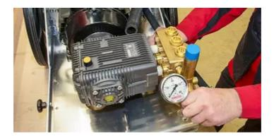
Die wohl aufwändigste Wartungsarbeit ist das Wechseln der Kolbendichtungen im Pumpenkopf. Hierfür lösen Sie zunächst die in diesem Fall acht M10-Innensechskantschrauben des Kopfes. Ziehen Sie diesen anschließend vom Getriebegehäuse ab. (Bildquelle: Bertling)
