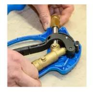
Es kommt vor, dass das Ventil in der Pistole nicht mehr richtig schließt und der Hebel nicht mehr in die Endposition gedrückt wird. Dies liegt an einer defekten Rückstellfeder. Sie lässt sich einfach tauschen, indem Sie zunächst das Gehäuse aufschrauben und die Ventileinheit herausnehmen. Beachten Sie die richtige Position auf den Führungsdornen. (Bildquelle: Bertling)
