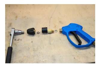
In unserem Beispiel wird die Kupplung mit einem 14er-Inbus von der Pistole abgeschraubt. Um den O-Ring der Lanzenkupplung zu tauschen, muss zunächst noch das Zwischenstück losgeschraubt werden, in dem der O-Ring eingelegt wird. Neben dem O-Ring kann im gleichen Zuge auch der Kunststoffring zwischen Pistole und Zwischenstück erneuert werden. (Bildquelle: Bertling)
