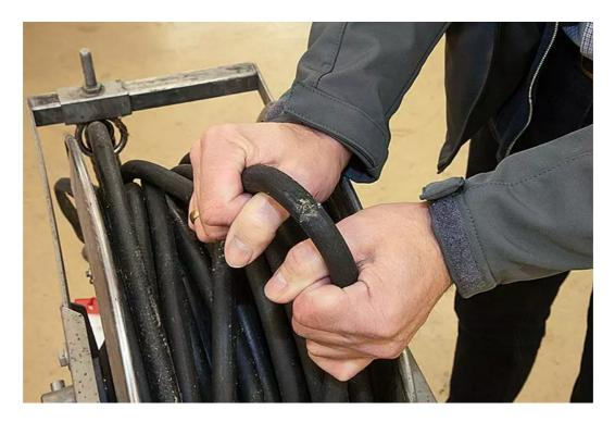
Schauen Sie sich die Ummantelung des Stromkabels und des Hochdruckschlauchs an. Diese sollten keine Beschädigungen aufweisen. Was viele nicht wissen: Hochdruckschläuche sollten alle sechs Jahre ausgetauscht werden. (Bildquelle: Bertling)
