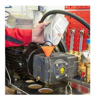
Herstellerseitig wird ein Getriebeölwechsel alle 500 Betriebsstunden empfohlen. Nehmen Sie nur spezielles Hochdruckpumpenöl, das auch bei hohen Drehzahlen eine ordentliche Schmierung gewährleistet. (Bildquelle: Bertling)
