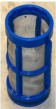
Werfen Sie regelmäßig einen Blick auf den Wasserfilter. Dieser befindet sich bei den meisten HD-Reinigern hinter der Kupplung des Zulaufschlauchs. Ist das Filtersieb verschmutzt, spülen Sie diesen mit klarem Wasser aus. (Bildquelle: Bertling)
