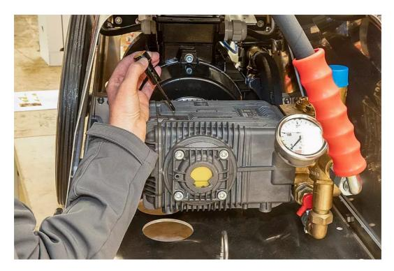
Prüfen Sie den Getriebeölstand über das Schauglas oder den Ölpeilstab. Ist die Farbe des Öls milchig, kann dies auf Wassereintrag hinweisen. In diesem Fall sollten Sie einen Dichtungswechsel am Pumpenkopf und einen Ölwechsel durchführen. (Bildquelle: Bertling)
