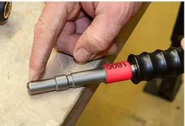
Stellen Sie die Lanze bei einem Wechsel nie auf die Kupplungsseite, sondern hängen diese am besten direkt in eine Halterung am Hochdruckreiniger oder an die Wand. Ansonsten können Einschläge und Kratzer am Stecker zu Undichtigkeiten führen, da die Dichtung in der Kupplung beim Einstecken beschädigt wird. (Bildquelle: Bertling)
