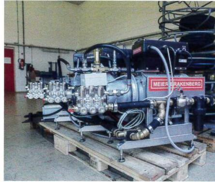
**Kundenorientierte Konfiguration:** Die frequenz-gesteuerten Hochdruckpumpen können mitein-ander kombiniert werden und machen so aus-reichend Druck für bis zu 30 Wäscher.
