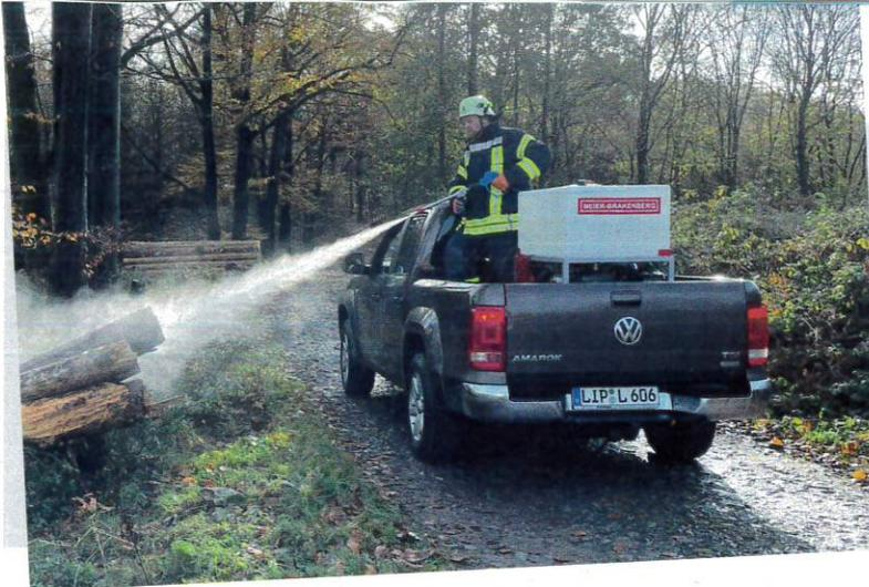
Ein Pick-up oder ähnliche Fahrzeuge lassen sich mit dem MB FastAttack zu geländefähigen Löschfahrzeugen aufrüsten.
