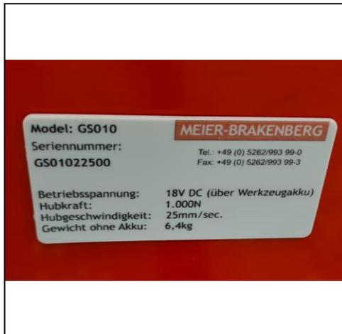
Das Typenschild befindet sich unter dem Bedienfeldgehäuse.
