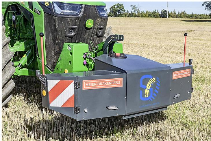
Field Attack ist die Kombination aus Unterfahrerschutz (Bumper), Frontgewicht und Löscheinheit. Basis der Löscheinrichtung ist ein geschützt installierter Hochdruckreiniger. Fotos: Tovornik, Hersteller (1)
