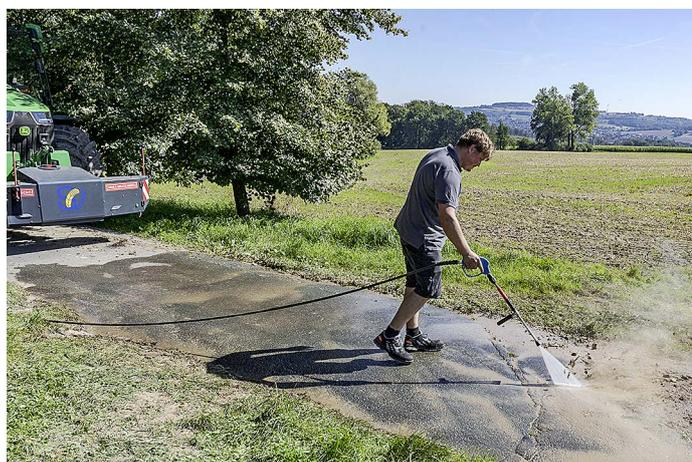
Zum Reinigen von Straßen kann die Handpistole, optional auch die untergebauten Bumper-Hochdruckdüsen, verwendet werden.
