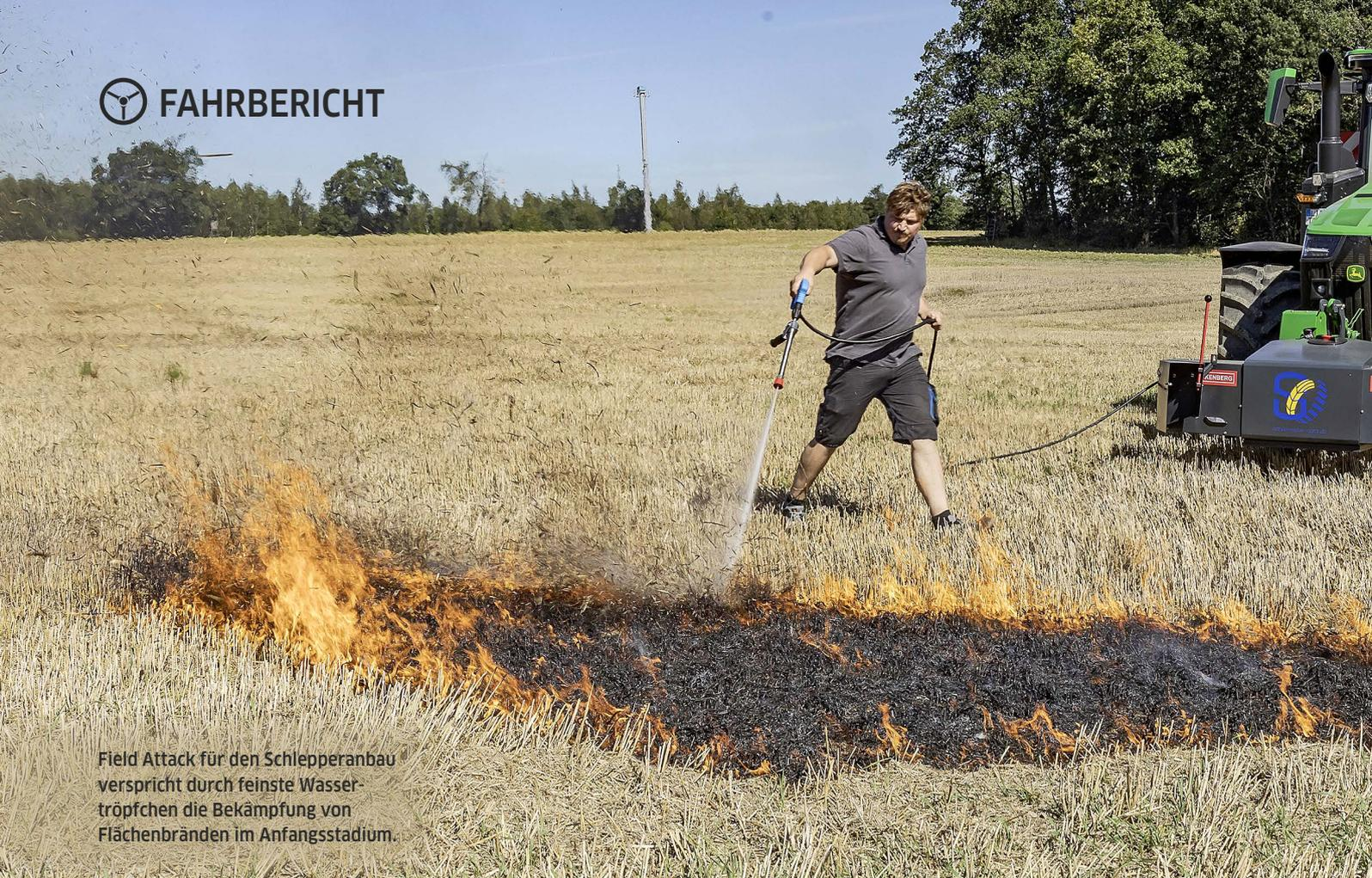
Field Attack für den Schlepperanbau verspricht durch feinste Wassertropfchen die Bekämpfung von Flächenbränden im Anfangsstadium.
