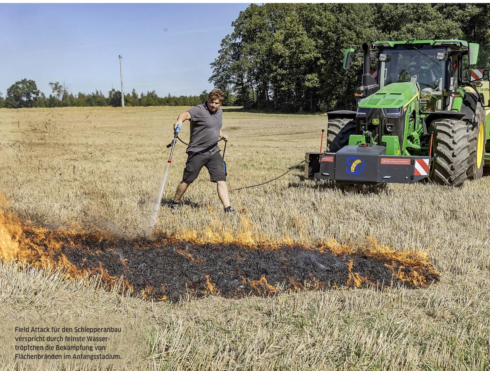
Field Attack für den Schlepperanbau verspricht durch feinste Wassertropfen die Bekämpfung von Flächenbränden im Anfangsstadium.
