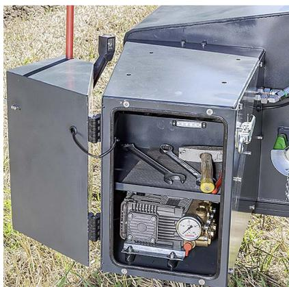
Die Pumpe befindet sich zusammen mit einem Werkzeugfach auf der linken Seite.
